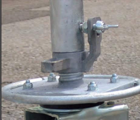
Die Spindel der 11,9 kN Fahrrolle ist mit einem Außenring ausgestattet, der das Auf- und Abspindeln wesentlich erleichtert. Gleichzeitig verhindern Form und Durchmesser des Außenrings die Verletzungsgefahr an Kanten.
