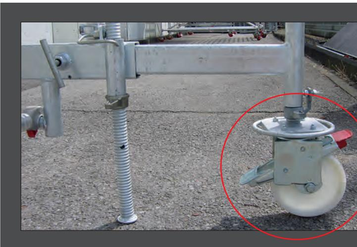
Nur eine Fahrrolle für alle plettac Aluminium Sicherheitsfahrgerüste, unabhängig von der Aufbauhöhe. Das macht die 11,9 kN Fahrrolle mit Ø 200 mm möglich. Die hochwertige Ausführung mit Doppelbremswippe erhöht zudem die Standsicherheit.
