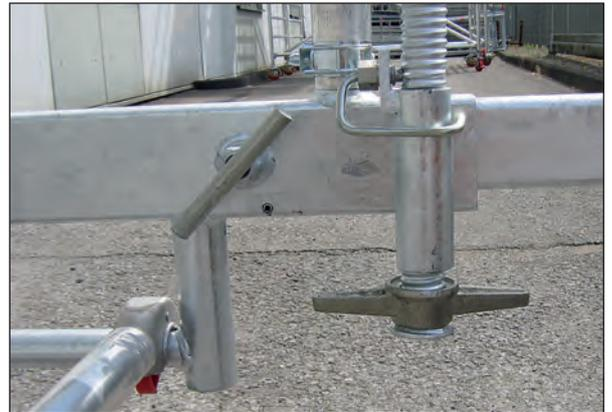
Fahrbalken bilden die sichere Gerüstgrundlage bei größeren Aufbauhöhen und im Freien. Um Ihr Fahrgerüst flexibel einzusetzen, können Sie zwischen verschiedenen Alternativen wählen, dem einfachen Fahrbalken oder einer teleskopierbaren Version.
