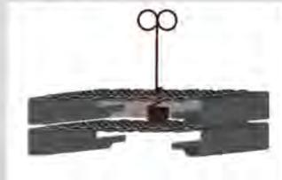
Befestigung von systemfreien Stahlböden auf systemfreien Stahlböden.
