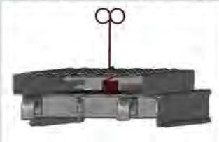
Befestigung von systemfreien Stahlböden auf Systemstahlböden. Unabhängig vom Lochbild der Stahlböden.
